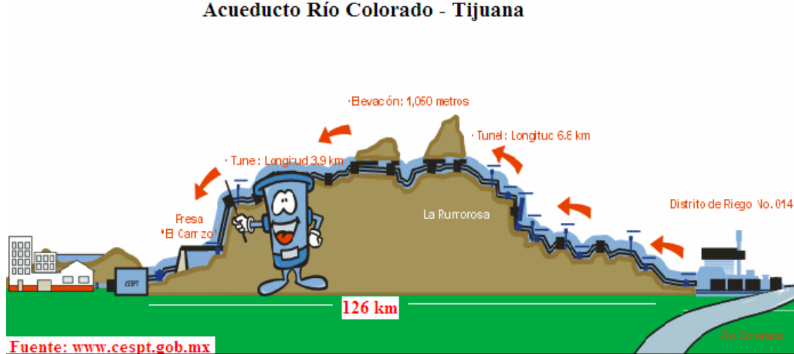
Figura 6.1. Esquema del recorrido que hace el agua por el acueducto Río Colorado-Tijuana hasta la presa el carrizo.
